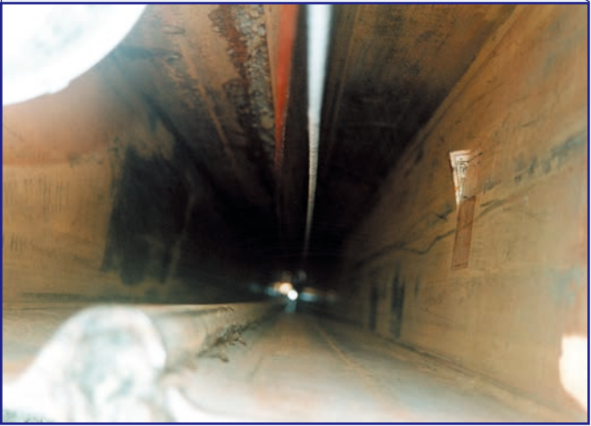
実物試験による止水性確認状況 BX400、打設長13m、GL-10.0mまで継手閉合部内部を排土・清掃 地下水位 GL-4.0m
