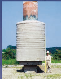
Đường kính có thể mở rộng đến 2 lần so với thân cọc
