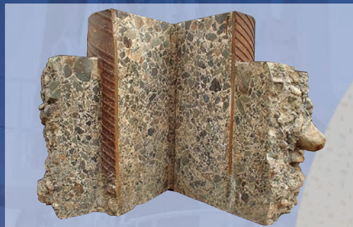
Ví dụ về sự hình thành mũi cọc Gantetsu™ (một mẫu lát cắt chu vi của cọc liên hợp có đường kính 1.400mm và ống thép có đường kính 1.000mm)
