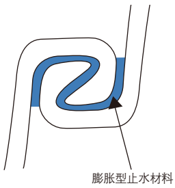
使用止水材料后的锁口啮合状态
