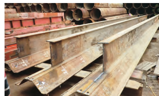
6次打桩试验后
