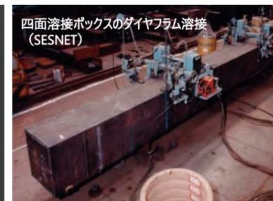
四面溶接ボックスのダイヤフラム溶接（SESNET）
