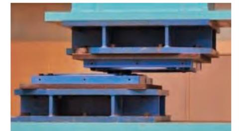
【水平移動時の変形状況 (実験状況)】
