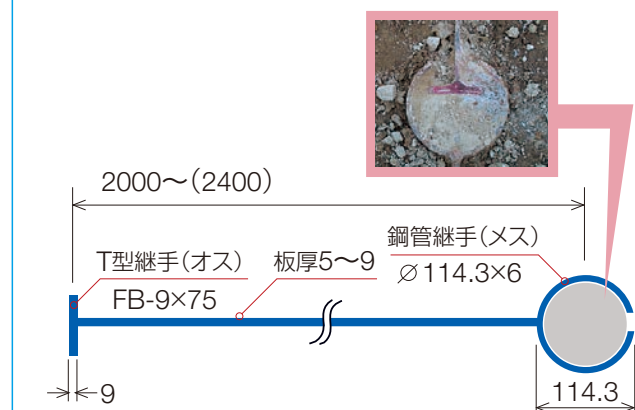
遮水パネル(P-Tモルタル継手)
