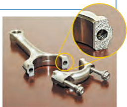
クラッキングコンロッド(左上:破断分割面)
