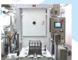
真空炭化炉(試験設備)
