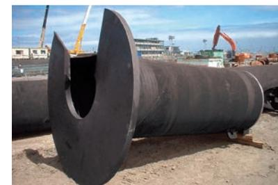
螺旋状の羽根(鋼管の先端)
