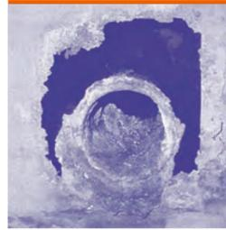
煙突内筒の硫酸露点腐食
