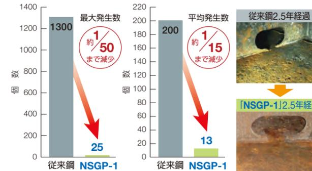
従来鋼適用船は5年たつと、深さ4mm以上の孔食がタンクあたり、最大1300個発生するのに対し、NSGP-1を使用すると約50分の1、平均でも約15分の1の発生に抑えられています。
