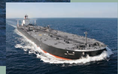
船名: TSURUGA(敦賀) 竣工: 2009年10月 全長: 333m 全幅: 60m 重量トン数: 約30万トン
