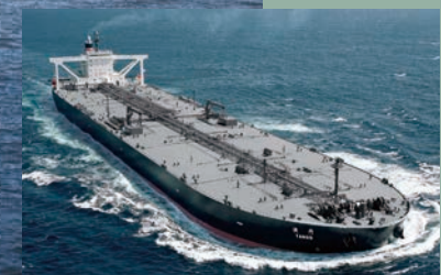
船名: TANGO(丹後) 竣工: 2009年10月 全長: 333m 全幅: 60m 重量トン数: 約30万トン
