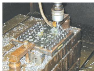
ABREXは高硬度・難加工材のため、穴あけ加工にはマシニングセンタと超合金ドリルの組み合わせが最適と考えられます。
