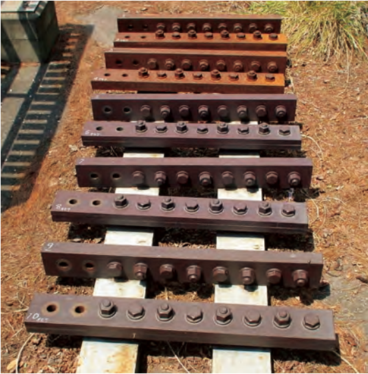
写真9-1 曝露試験状況
