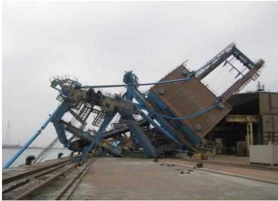
漂流した船によって損傷を受けた岸壁クレーン
