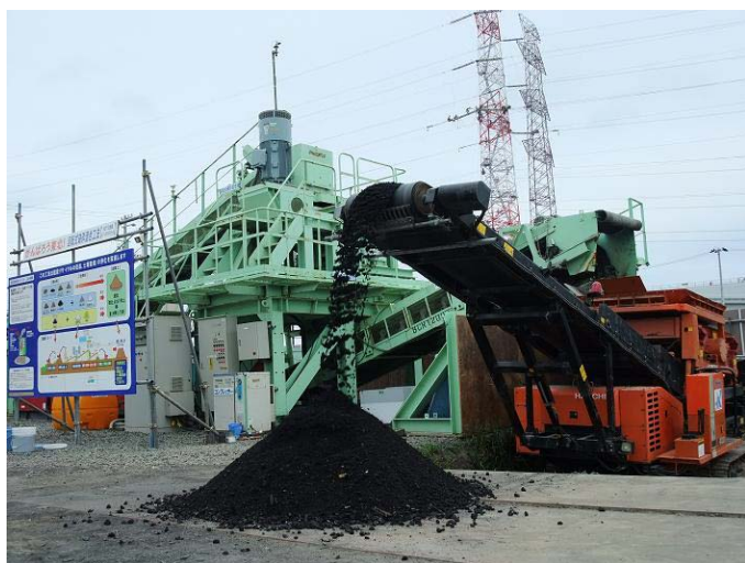
回転式破碎混合プラントと改質された良質な土
