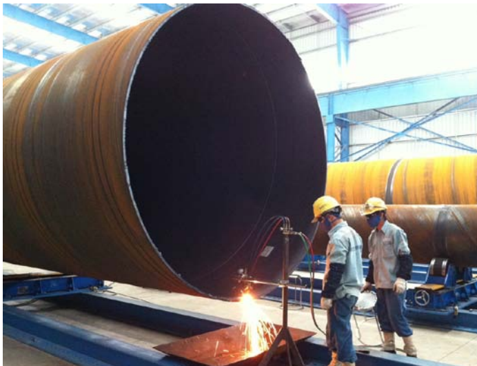
工場内部（直径 2700mm 超の鋼管杭）
