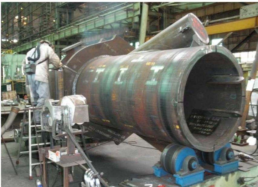
図3 ゲイン塔 (PHYP700PB 鋼管) 製作状況
