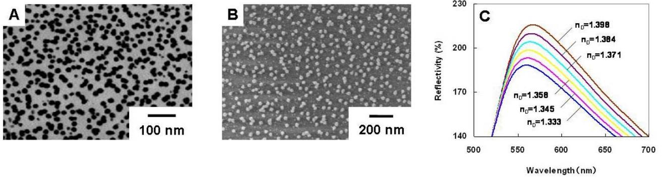
図1 (A) 銀ナノ粒子を均一分散したポリマーナノコンポジット材料の断面TEM像。(B) 金ナノ粒子を表面に析出させた金ナノ粒子均一分散ポリマーナノコンポジット材料表面のSEM像。(C) 金ナノ粒子を表面に析出させたポリマーナノコンポジット材料を屈折率の異なる液体に浸漬させた際の反射スペクトル測定結果。
