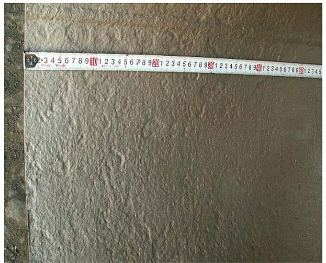
鋼管内面の錆層をショットで落とした後の外観: 全面腐食になっており、クレーターはあるものの、局部的に深い腐食は見られない。
