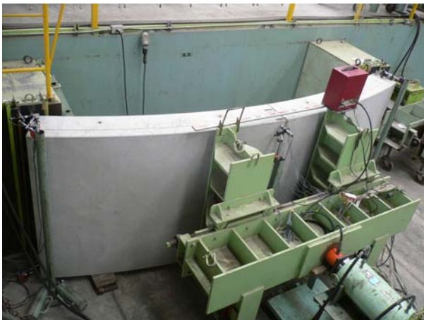
外径φ12m級の大口徑セグメント 曲げ試験 実施中
