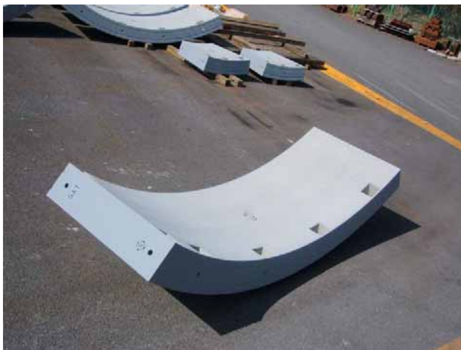
写真.2 京王線・調布駅付近連続立体交差工事(土木)第4工区で採用された コンクリート中詰め合成セグメントの製品
