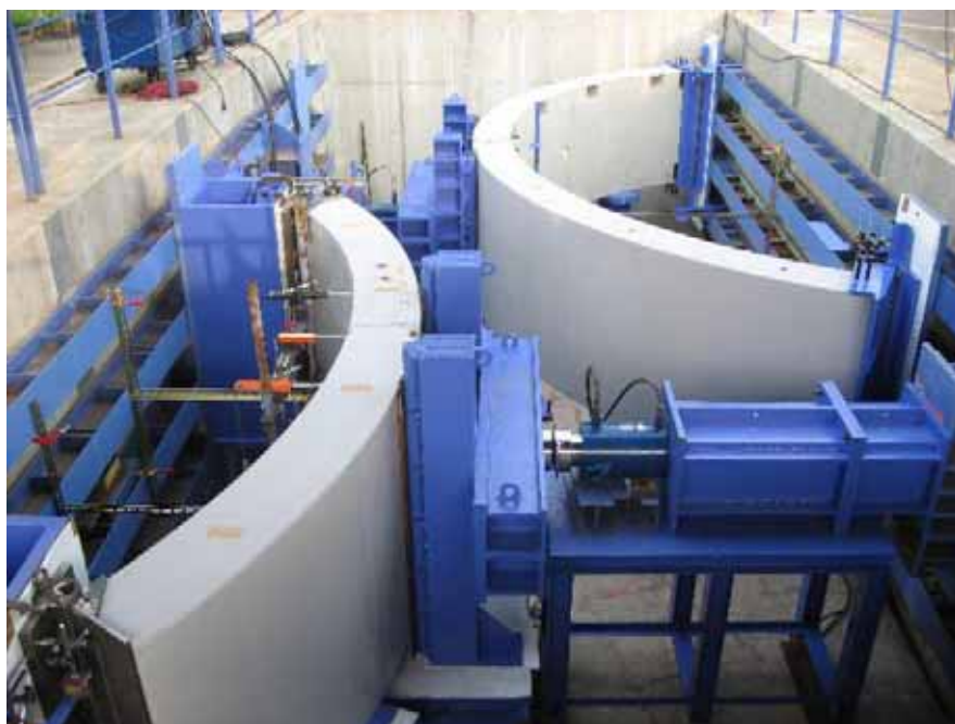
写真.4 本体曲げ試験・継手曲げ試験の载荷状況
