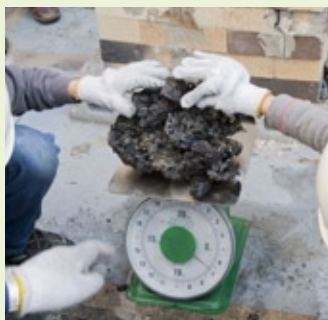
炉の中からケラを取り出す。水に入れ「ジュワッ」という音と同時に水蒸気が上がると、子どもたちから歓声が上がった。1班は6.6kg、2班は7.9kgと立派なケラができて上がった。
