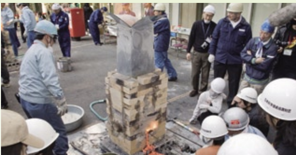
うまくノロが出るか、みんなが真剣に見守る中、底羽口(そこはぐち)から真っ赤なノロがゆっくりと流れ始める
