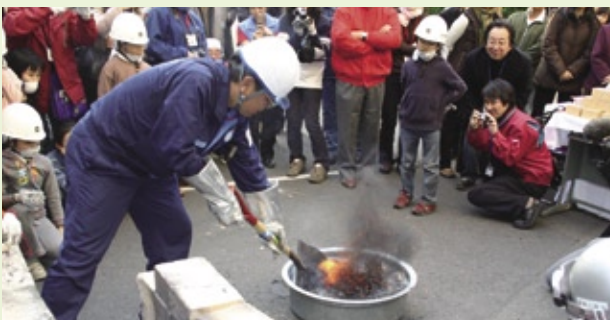
炉の中からケラを取り出す。水に入れ「ジュワッ」という音と同時に水蒸気が上がると、子どもたちから歓声が上がった。1班は6.6kg、2班は7.9kgと立派なケラができて上がった。
