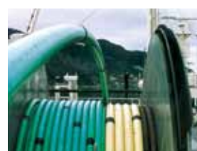
海底パイプラインとして敷設されるスーパー13クロム鋼管
