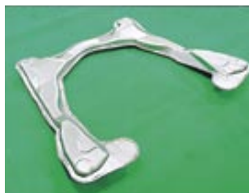
サスペンションメンバー （ハイドロフォームによる試作品）
