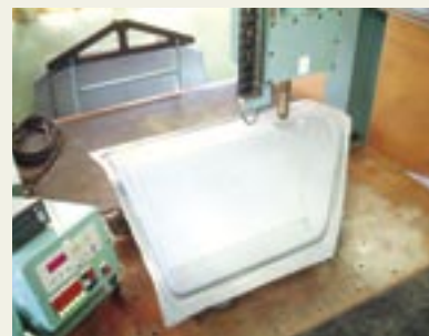
性能測定中のドアパネル
