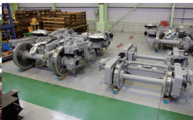
新幹線(左)と路面電車(右)の台車
