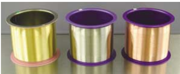
ボンディングワイヤ (左：金ワイヤ、中央：被覆銅ワイヤ (EX1)、右：銅ワイヤ)
