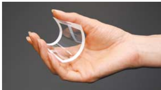
「シルプラス」によるタッチパネル用導電透明フィルム(携帯電話向け)
