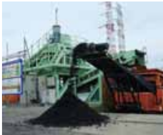
回転式破碎混合プラントと改質された良質な土
