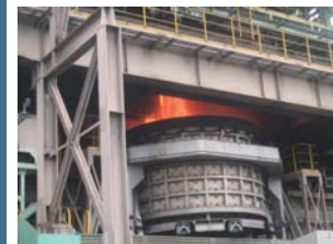
大分製鉄所第5コークス炉 2008年5月稼働。投資額370億円。 生産能力100万トン/年。
