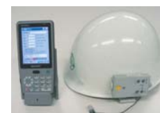
騒音下音声認識システムと携帯端末
