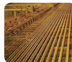
鉄道向け騒音・振動対策 世界最長150mレール
