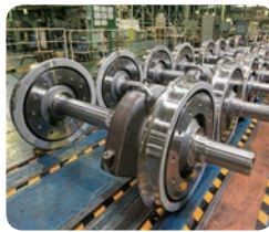
鉄道向け 軽量化・高速化による 省エネルギー 高速鉄道用輪軸 (車輪・車軸)
