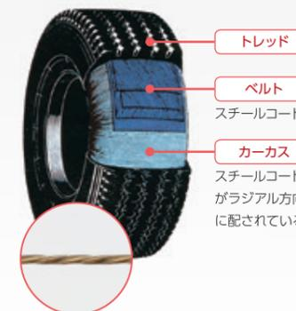
タイヤの補強材として使われるスチールコード。直径0.2~0.3ミリの細線を撚り合わせたコードを、ゴムなどとともに加工してタイヤをつくる
