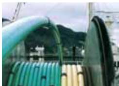
海底パイプラインとして敷設されるスーパー 13クロム鋼管
