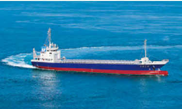
リチウムイオン電池搭載型 ハイブリッド貨物船「うたしま」 (シップ・オブ・ザ・イヤー2019 小型貨物船舶部門賞受賞)
