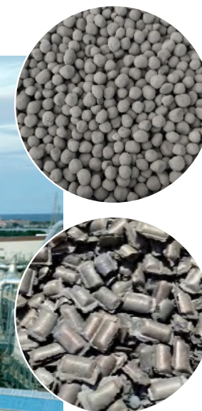
試験還元炉で製造した水素還元鉄
