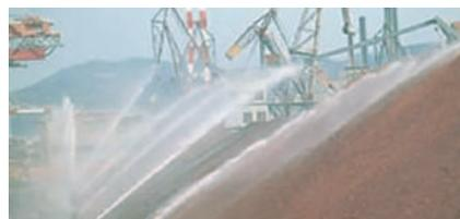
鉄鉱石や石炭の山に散水や薬剤散布をして、原料の飛散を抑制します。
