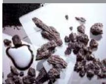
コーラルタールやコークス炉ガス等の製鉄副産物を原料として活用し、電炉用電極向けニードルコークスや自動車タイヤ用カーボンブラック、各種化学品類を生産しています。
