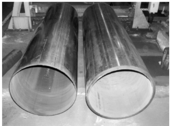
Left: 609.6mmφ × 6.0mmt (24"φ × 0.24"t), t/D = 1.0%, Right: 609.6mmφ × 22.0mmt (24"φ × 0.87"t), t/D = 3.6%
