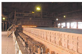
焼結機(鹿島):製鉄原料としてダスト、スラッジなど鉄鋼副産物を再利用
