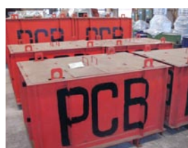
PCB含有廃棄物保管状況(特殊管)
