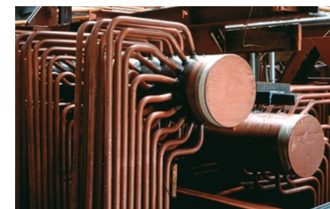
火力発電に使用 されるステンレス ボイラチューブ
