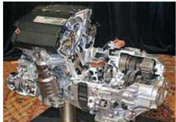
無方向性電磁鋼板を用いた高効率モータ例
