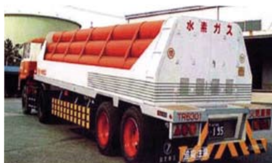
水素ガス用長尺容器 (710リットル×20本組セミトレーラーカードル)
