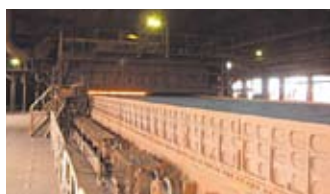
焼結機(鹿島):製鉄原料としてダスト、スラッジなど鉄鋼副産物を再利用
