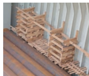
間伐材の活用 (船による鋼管輸送時の緩衝材)
