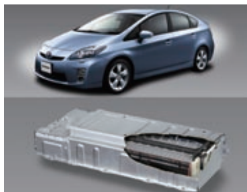
ハイブリッド自動車(上)とニッケル水素電池(下) ※写真提供:トヨタ自動車(株)
