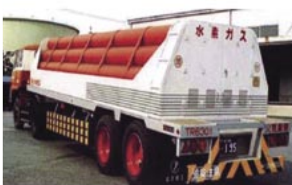
水素ガス用長尺容器 (710リットル×20本組セミトレーラカードル)
