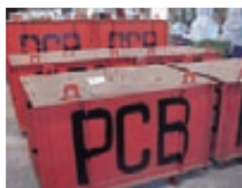
PCB含有廃棄物保管状況(特殊箱)
