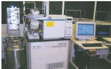
ガスクロマトグラフ2段分離飛行時間型質量分析器
