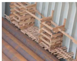
間伐材(船による鋼管輸送時の緩衝材)
