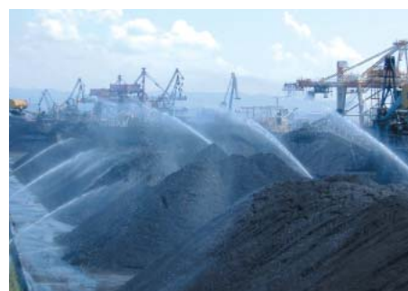
原料ヤード散水
