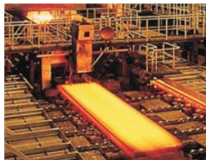
連続鋳造設備
