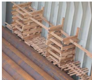
船による鋼管輸送時の緩衝材としての間伐材
