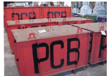
PCB含有廃棄物保管状況
