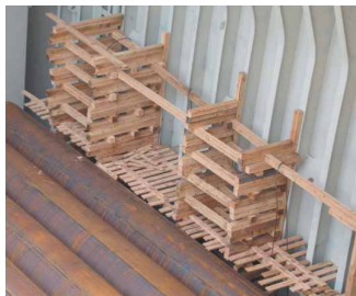
船による鋼管輸送時の緩衝材としての間伐材
