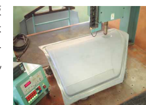
性能測定中のドアパネル
