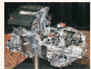
27SXHを使用したモータ(発電機兼用)
