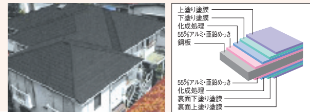
住友遮熱カラー鋼板を使用した屋根
