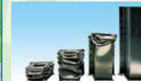
落下衝撃試験(中の2体がハイテン)
