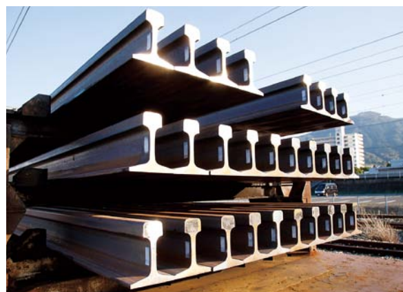
新幹線用レール
