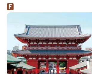
新日本製鉄(株) 寺社仏閣のチタン屋根 300年の耐久性を有し、環境にやさしく周囲の景観にマッチした美しい新日鉄のチタン屋根。金閣寺の茶室や浅草寺など、伝統的な寺社仏閣の屋根に使われています。
