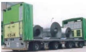
電動式完全無人自動運行制御輸送台車
