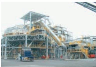
回転炉床式ダストリサイクル設備(広畑製鉄所)
