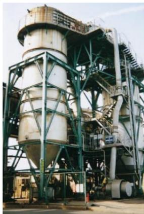
排ガス加熱・急冷設備
