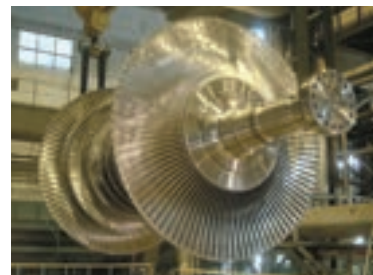
タービンブレード【最終段42インチ長翼】 Turbine blade (42 inches long at the last row)
