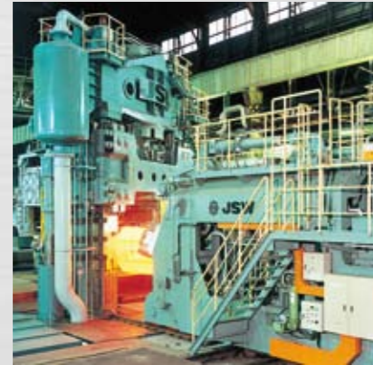
■3,000t油圧プレス(高性能マニピュレーター付帯)
