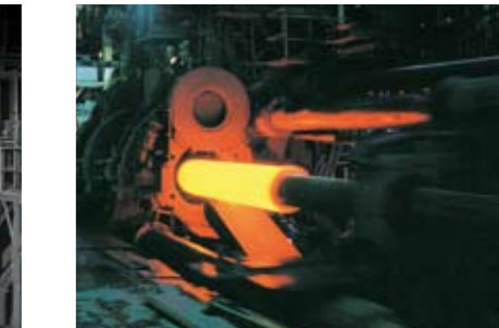
熱間押し製管機 Horizontal push bench
